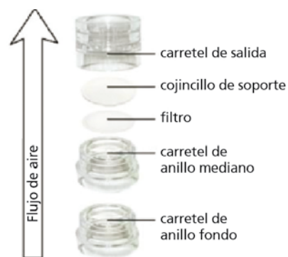
TOMA DE MUESTRA EN FILTROS Material particulado
